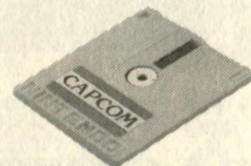
ファミコンの本体、ラムアダプタ、ディスクドライブの3つを正しく接続し、本体の電源を入れる。するとタイトル画面が出てくるので、ディスクカードのSIDE・Aを上にしてセットします。(画面が出ない場合は、接続を確認して下さい。)
