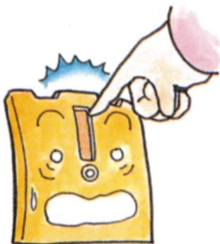
●ディスクカードの窓から見える茶色の磁気フィルム部分には、絶対に指などで、直接触れないで! それから、その部分を汚したり、傷つけたりしないようにも気をつけよう!
