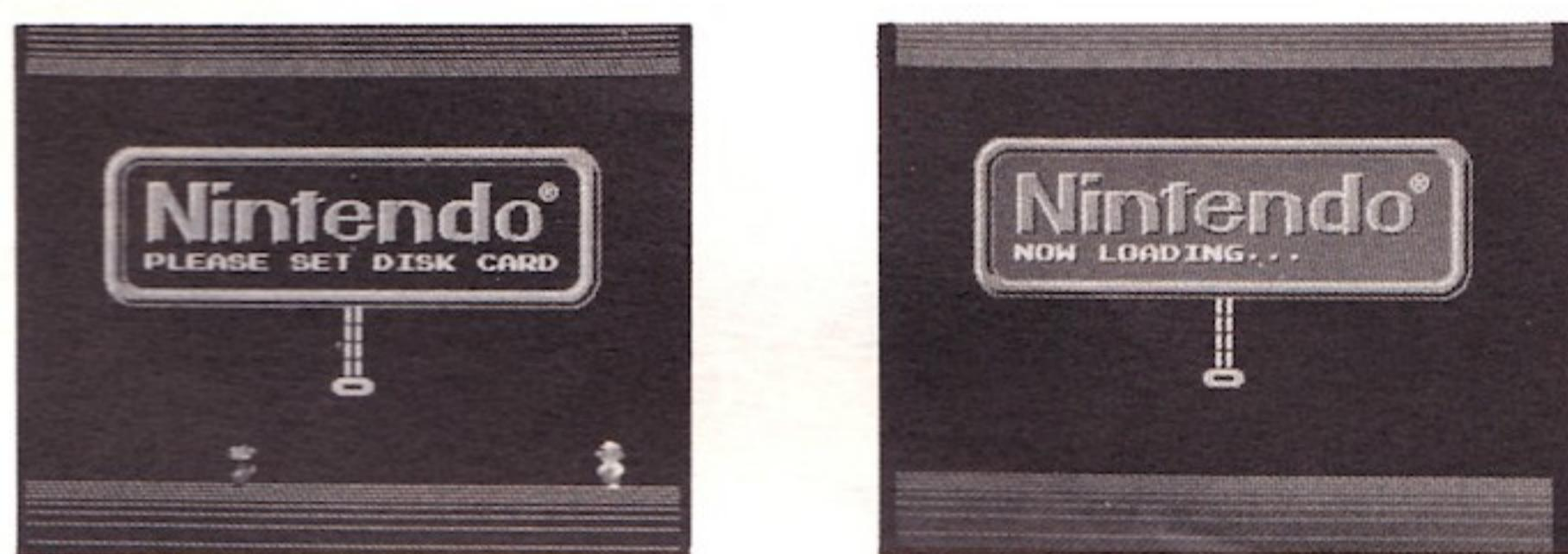
右上の“NOW LOADING…”という画面が出たあと、しばらくすると、下のような画面が出てきます。もし出でに“A、B SIDE ERR.07”という表示が出たときは、ディスクカードを取り出し、SIDE A、Bをもう一度よく確認して、SIDE Aを上にセットしなおしてください。
